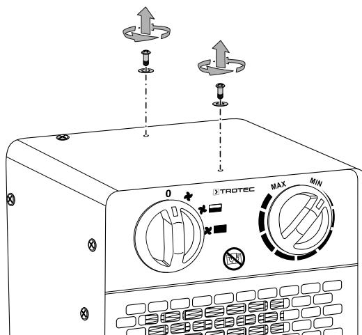
2. Ručku za transport montirajte vijcima i podložnim pločicama.
