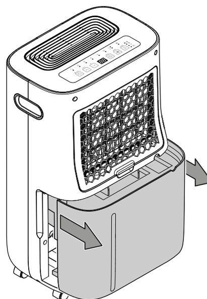
2. Esvazie o tanque de água condensada através de um dreno, p.ex. para um WC, um lavatório ou para uma pia.
