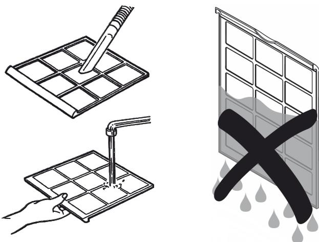
3. Deixe que o filtro seque por completo. Não colocar a cobertura da entrada de ar no aparelho, quando o filtro for molhado!
