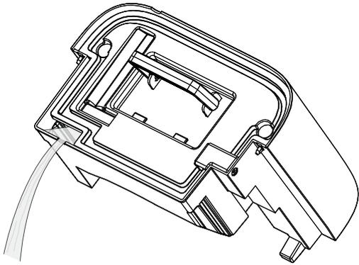
3. Lavar o tanque com água limpa. Limpe o tanque em intervalos regulares com um produto de limpeza brando (nenhum detergente!).
