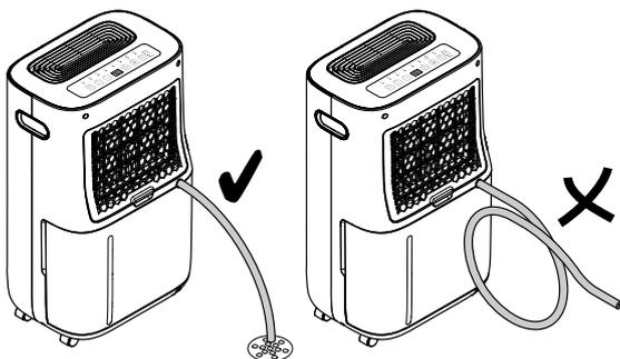
5. Remover a mangueira se quer recolher o condensado através do tanque de água condensada. Deixar secar a mangueira antes do armazenamento.
