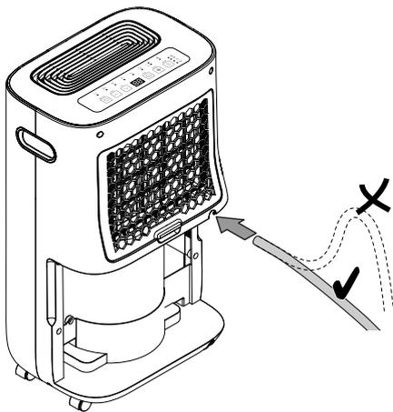
3. Coloque o tanque de água condensada de volta na máquina. Nisso, certifique-se que a mangueira de purga da água condensada não se moveu ou saiu da conexão.
