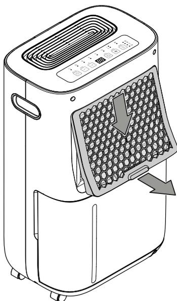
2. Limpe a cobertura e o filtro integrado com um pano macio, sem fiapos e ligeiramente humedecido. Se o filtro for muito sujo, deve limpá-lo com água morna misturada com um detergente neutro.
