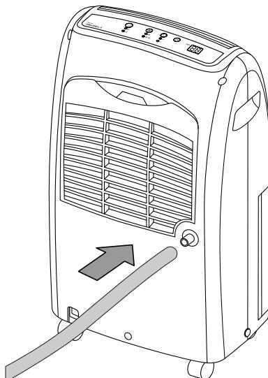
5. Проверьте, правильно ли шланг надет на патрубок. При необходимости откорректируйте положение через отверстие на емкости для конденсата.
